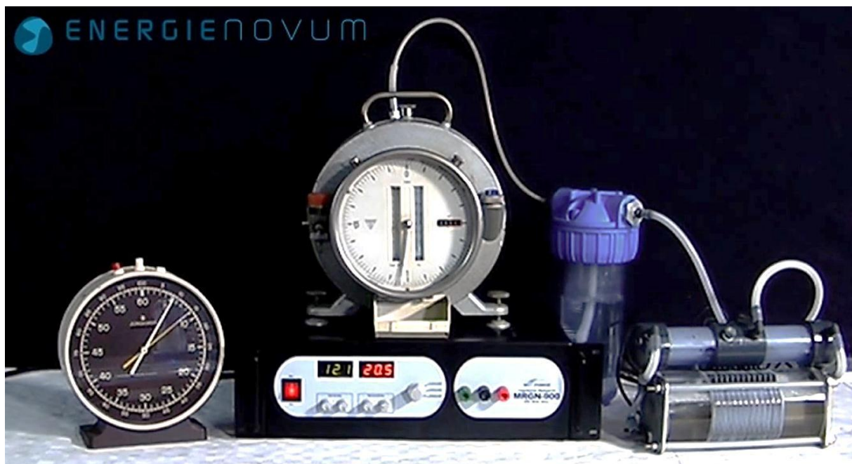
Testaufbau zur Messdatenerfassung des Elektrolyse-Stacks mit „TRAVELNOVA TN-S1“
