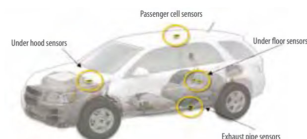
Abbildung 9: Anordnung der H 2 -Sensoren an Bord eines HydroGen4 [Sachs 2010]
